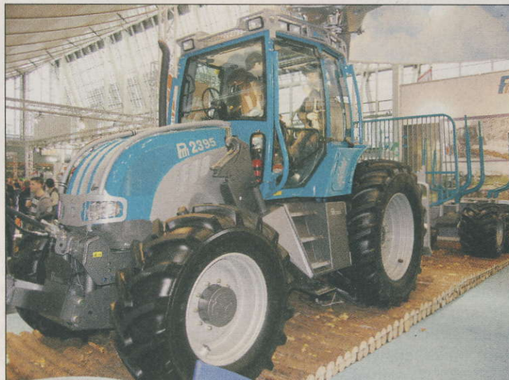
Für die Holzbergung entwickelte die Firma Pflanzelt ein Systemfahrzeug, das auf einem Standardschlepper basiert. Die Kabine wird um 50 cm vorgerückt, an den Traktorrahmen wird eine Aufnahme für Zusatzgeräte gebaut. Hinter den Trac ist ein Rückewagen für 18 Raummeter Holz gehängt.
