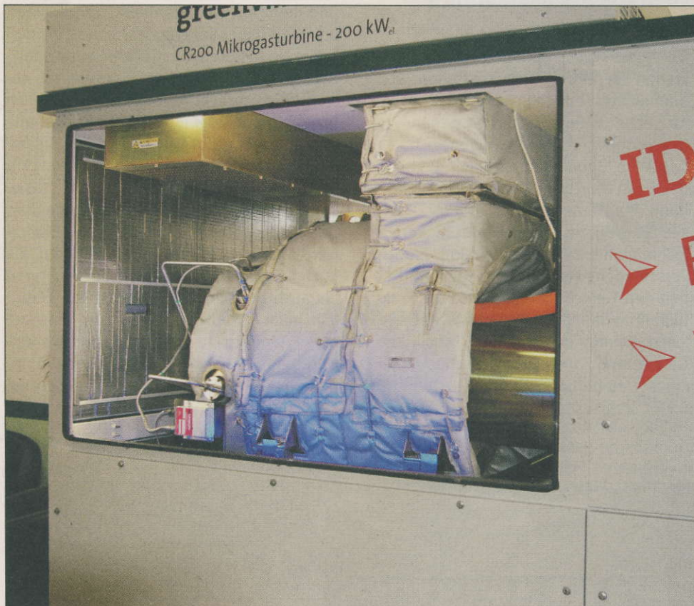
Die Firma Greenvironment zeigt eine Mikrogasturbine mit einer elektrischen Leistung von 200 kW. Vorteile dieser Technik sind der geringe Betriebsmittel- und Betreuungsaufwand sowie die geringen Abgas- und Lärmmissionen. Nachteil ist, dass der elektrische Wirkungsgrad geringer als bei BHKWs ist. Allerdings kann die Wärme bei der Turbine besser als bei einem BHKW genutzt werden.
