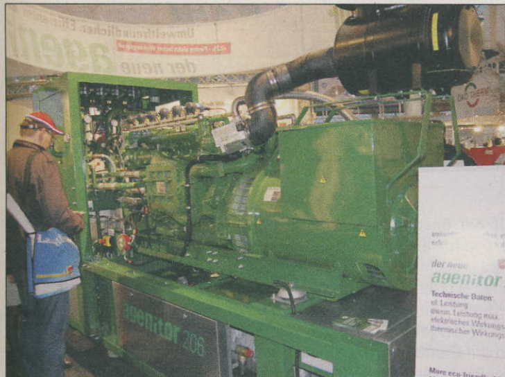
Die Baureihe Agenitor der Firma 2G sind Blockheizkraftwerke für den Einsatz von Biogas. Die Gasmotoren wurde von der Firma in Eigenregie weiterentwickelt und erreichen elektrische Wirkungsgrade zwischen 40 und 40,9 %. Die BHKWs werden mit der elektrischen Leistung zwischen 220 bis 265 kW angeboten.
